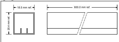
40 relays per tube, 30 tubes per box (1200 relays per box)
